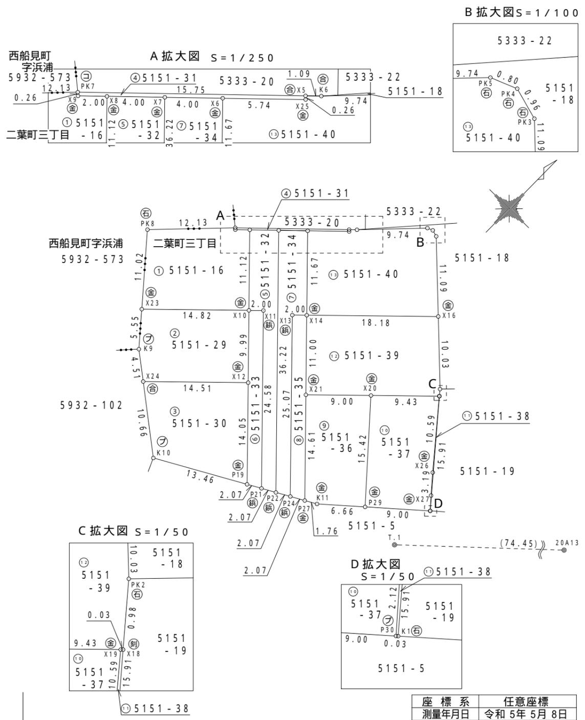
④ 金属標 · ③ コンクリート杭 · ② 合成樹脂杭 · ① 鉄杭 · ⑤ 石杭 · ⑥ 刻印 · ⑦ 金属プレート
